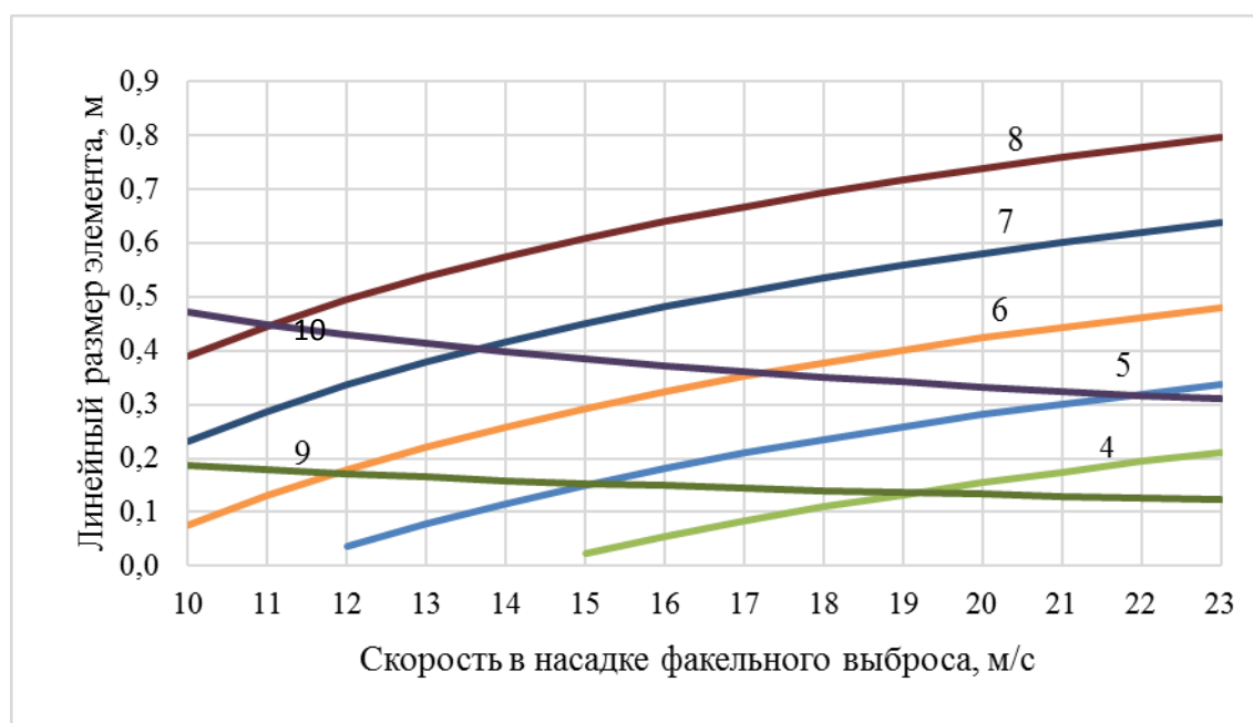
Рисунок 5 - К определению размеров конфузора и насадка факельного выброса при удалении воздуха в размере 4000 м 3 /ч при диаметре основного вытяжного воздуховода, м: 4 – 0,315; 5 – 0,355; 6 – 0,4; 7 – 0,45; 8 – 0,5; 9 – диаметр насадка, м; 10 – длина насадка, м.
